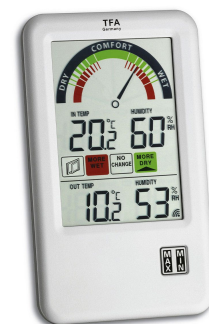
Abbildung 3 Beispiel für eine Lüftungsampel [Quelle: https://www.tfa-dostmann.de/ ]
