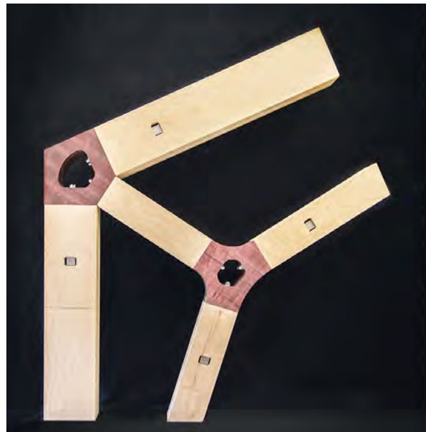
Abbildung 7.2 Knotenelement mit formschlüssigen Anschlüssen aus Kunstharzpressholz (links), aufgelöste Rahmenecke (rechts) [31]
