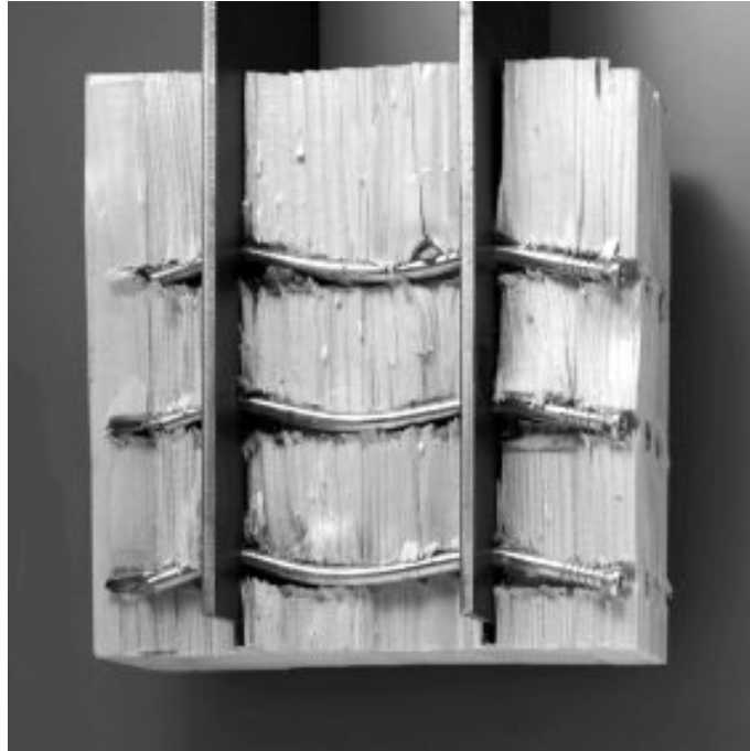
Abbildung 5.5 Zweischnittige Stahl-Holz-Verbindung nach Überschreiten der Tragfähigkeit der stiftförmigen Verbindungsmittel durch Ausbildung von Fließgelenken [19]
